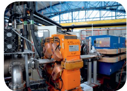
Magnete mit zwei Polen (blau) halten die Elektronen auf ihrer Bahn im Vakuumrohr des Speicherringes, Magnete mit vier Polen (orange) fokussieren den Elektronenstrahl.
