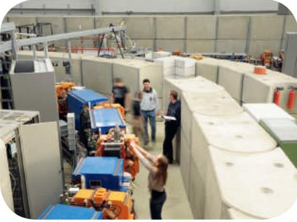
Bei abgeschalteter Beschleunigeranlage können auch innerhalb der Schutzmauer Wartungsarbeiten erledigt und neue Komponenten installiert werden.
